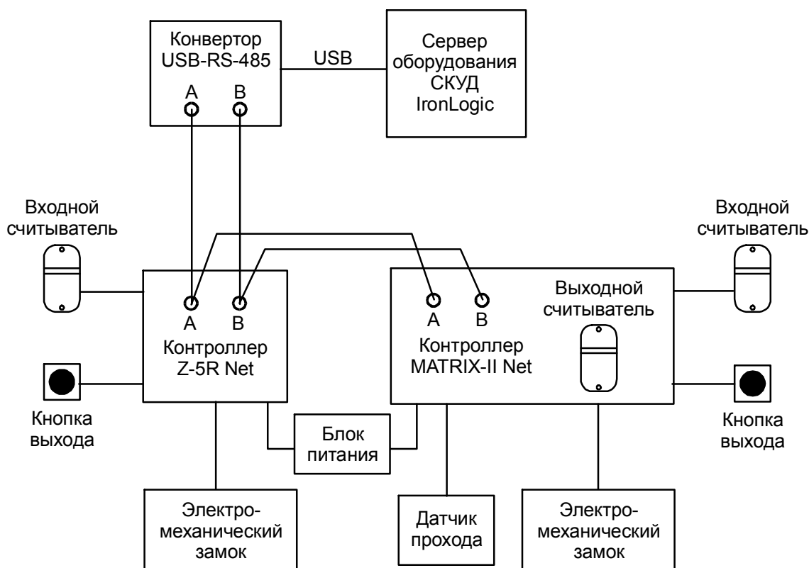
Рисунок 46 – Схема подключения для двух точек прохода
