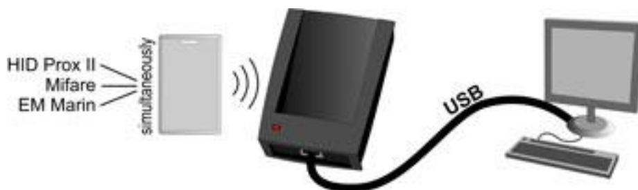
Рисунок 12 – Схема подключения адаптера Z-2 USB к компьютеру
